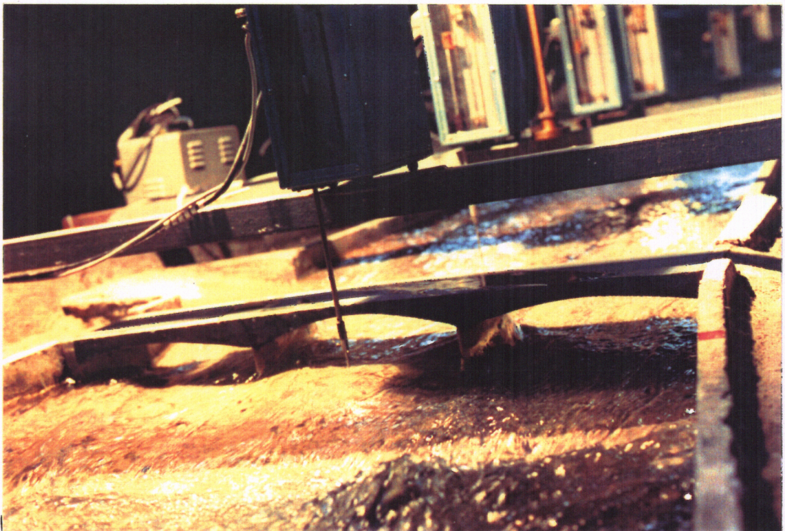
Nº 20. Q = 600 \text{ m}^3/\text{seg} . Puente de Armiñán
